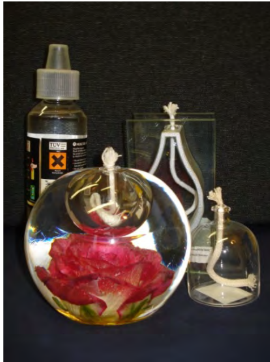
Abbildung 2: Unsichere Öllampen ohne Dochtschutz und kindersichere Einfüllöffnungen (alle Fotos: J. Langanki, RP Darmstadt)
