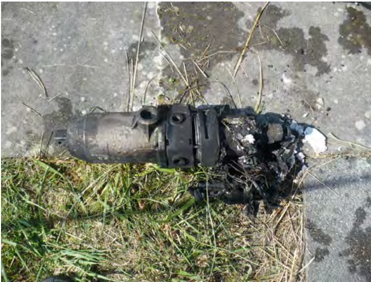
Abbildung 2: Reste des nicht explosionsgeschütz- ten Schlagschraubers
