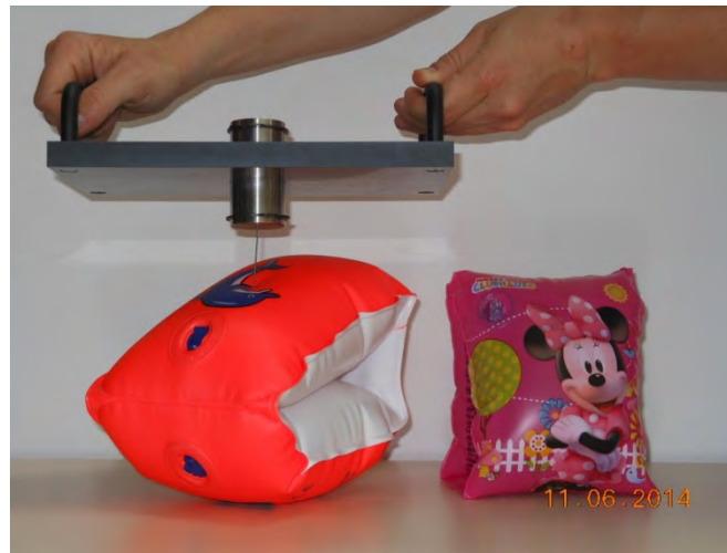
Abbildung 4: Prüfung zur Bestimmung der Stichfestigkeit
