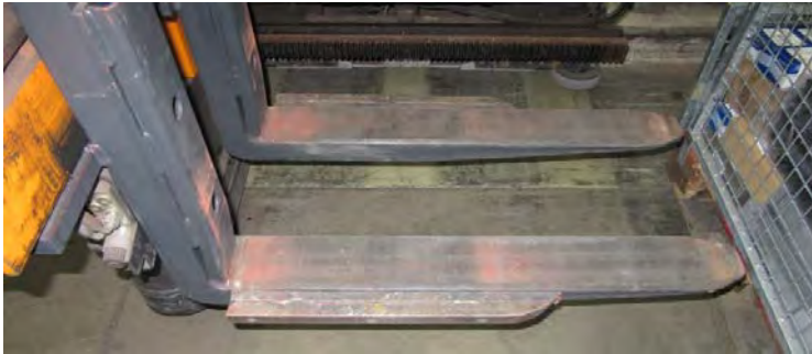
Abbildung 3: Gabelzinken mit vulkanisierter Gummierung
