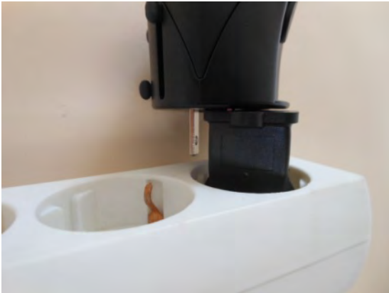
Abbildung 4: Berührbarer Stift durch falsch eingesteckten Adapter
