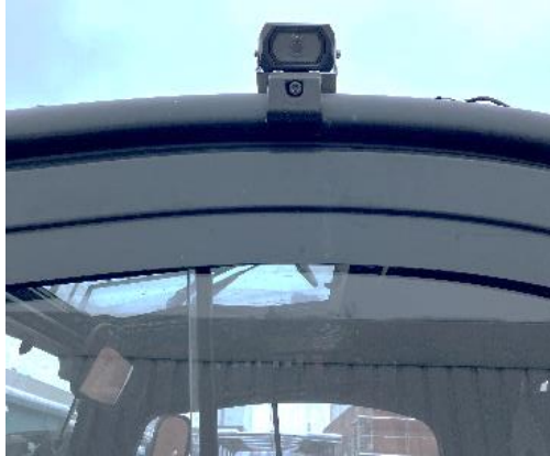
Abbildung 2: Eine der vier am Dach des Staplers montierten Kameras.
