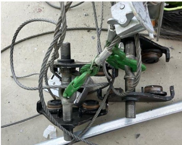
Abbildung 2: Rollenfahrwerk mit Halteseilen der Arbeitsbühne nach dem Absturz.
