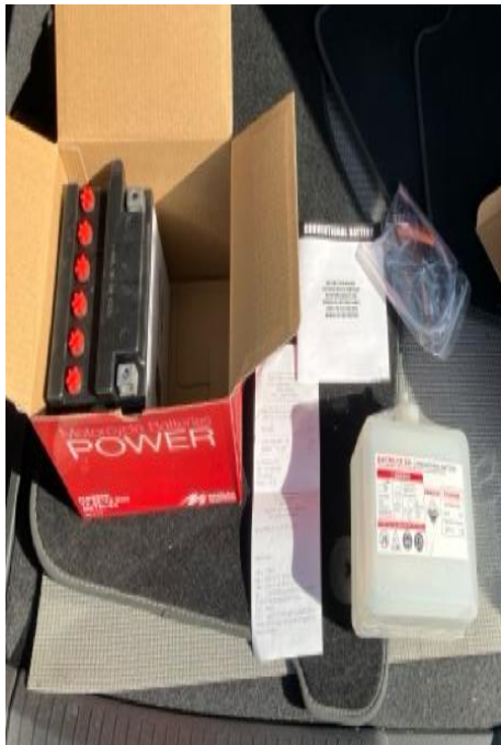
Abbildung 1: Motorradbatterie mit separatem Säurepack (weißer Behälter).
