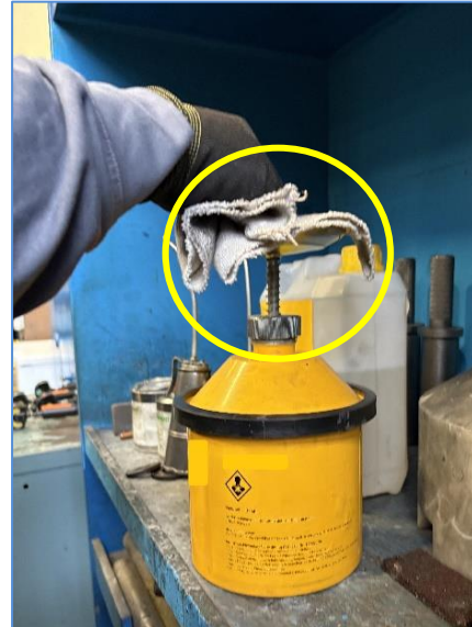
Abbildungen 1a und b: Unzureichender Hautschutz bei Tätigkeiten mit Gefahrstoffen (Fotos: Maya Weber).
