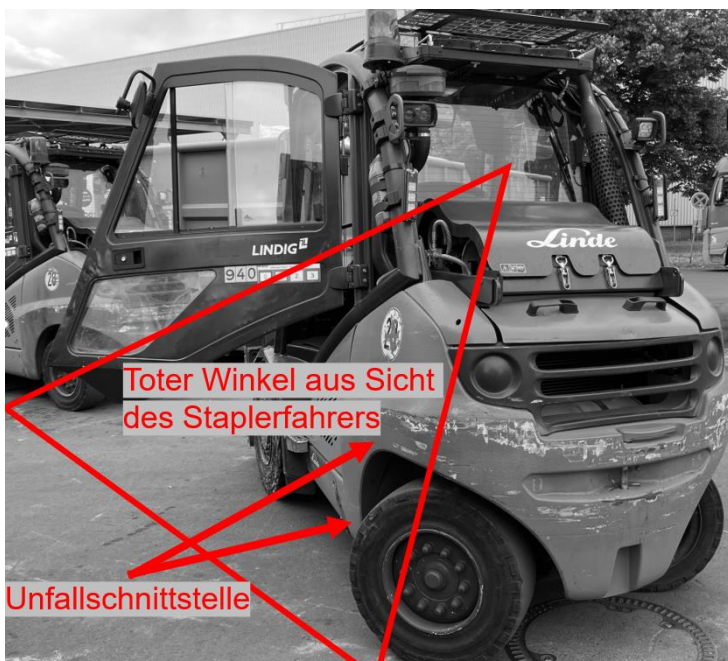
Abbildung 1: Schematische Darstellung des toten Winkels im hinteren Bereich des Staplers.
