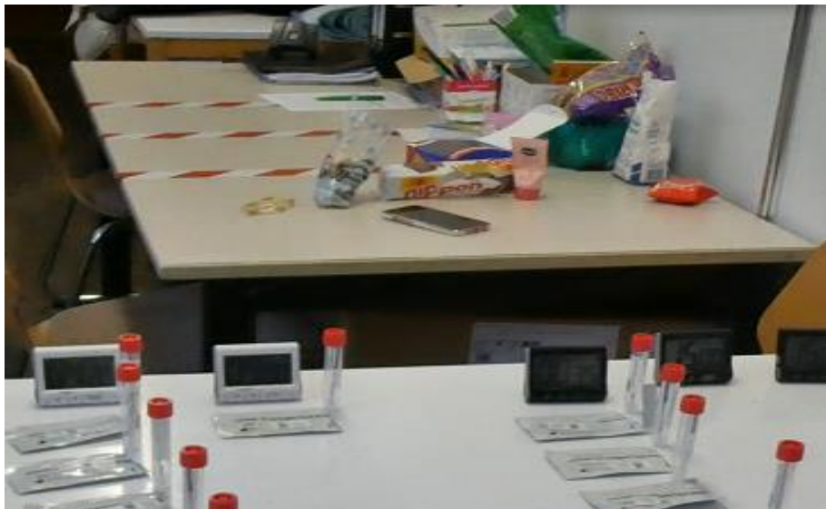
Abbildung 7: Offene Lebensmittel im Laborbereich, neben infektiösen Proben
