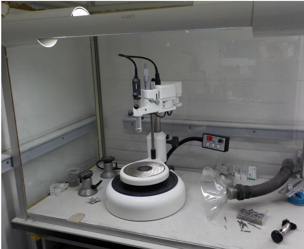
Abbildung 3: Teileingehauste Parallelfräse mit beweglicher Objektabsaugung
