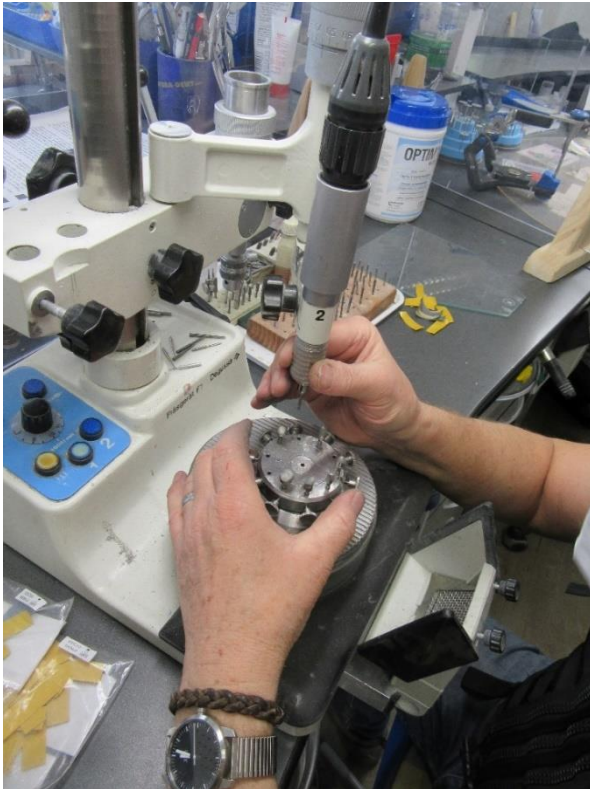
Abbildung 2: Arbeiten an der Parallelfräse
