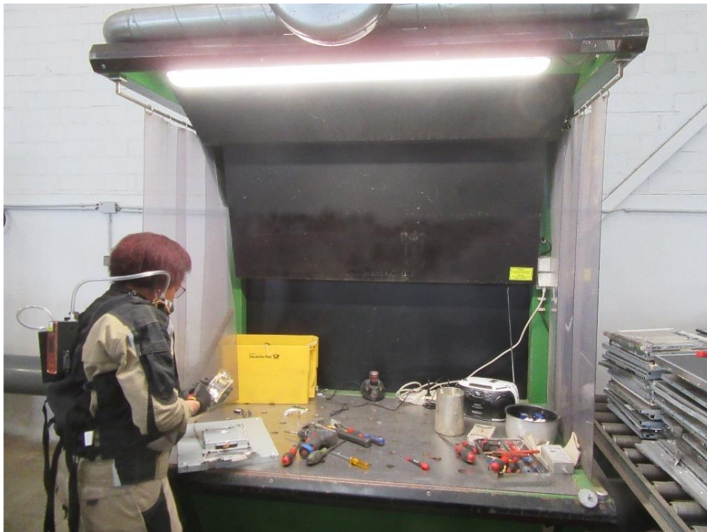
Abbildung 2: Abgesaugter Arbeitsplatz für die Demontage von Bildschirmgeräten
