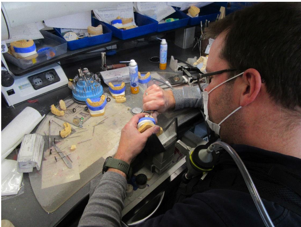
Abbildung 1: Ausarbeiten vor dem Absaugmaul
