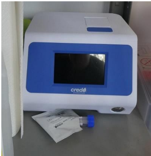
Abbildung 9: Unzulässiger Betrieb eines POC-NAT-Geräts im Regalboden
