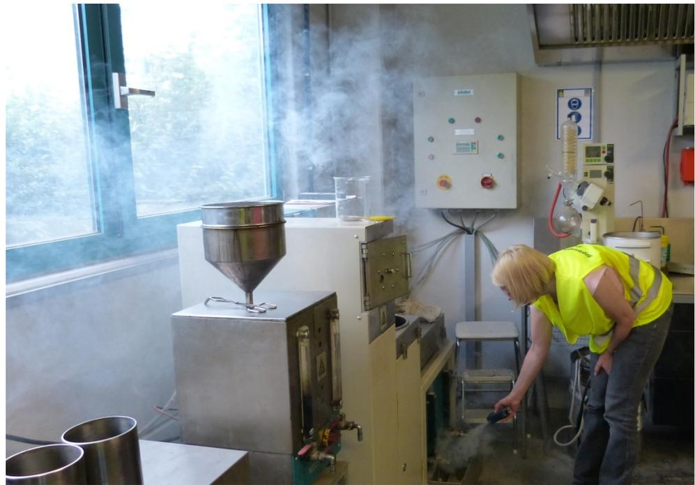
**Abbildung 1: Überprüfung der Wirksamkeit der Lüftungstechnik mit einem Nebelgenerator. Im Bodenbereich hinter dem Asphaltanalysator befindet sich ein Ventilator zur Absaugung der Raumluft in unmittelbarer Nähe der potenziellen Emissionsquelle. Da der Nebel keine Strömung in Richtung des Erfassungselementes zeigt, wird die Wirksamkeit der Lüftungstechnik als unzureichend bewertet.**
