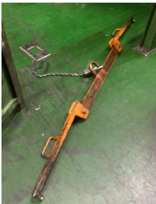
**Abbildung 3: Lastaufnahmemittel mit gerissener Kette**
