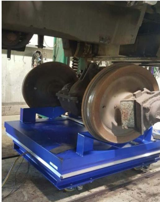
Der neue Arbeitsablauf ermöglicht die Montage in aufrechter Körperhaltung (Abbildung 5). Das Verfahren der Hebevorrichtung, auch unter voller Belastung durch die schwersten vorhandenen Lokomotivachsen (4,5 t), ist jetzt ohne Kraftanstrengung möglich (Abbildung 6).
