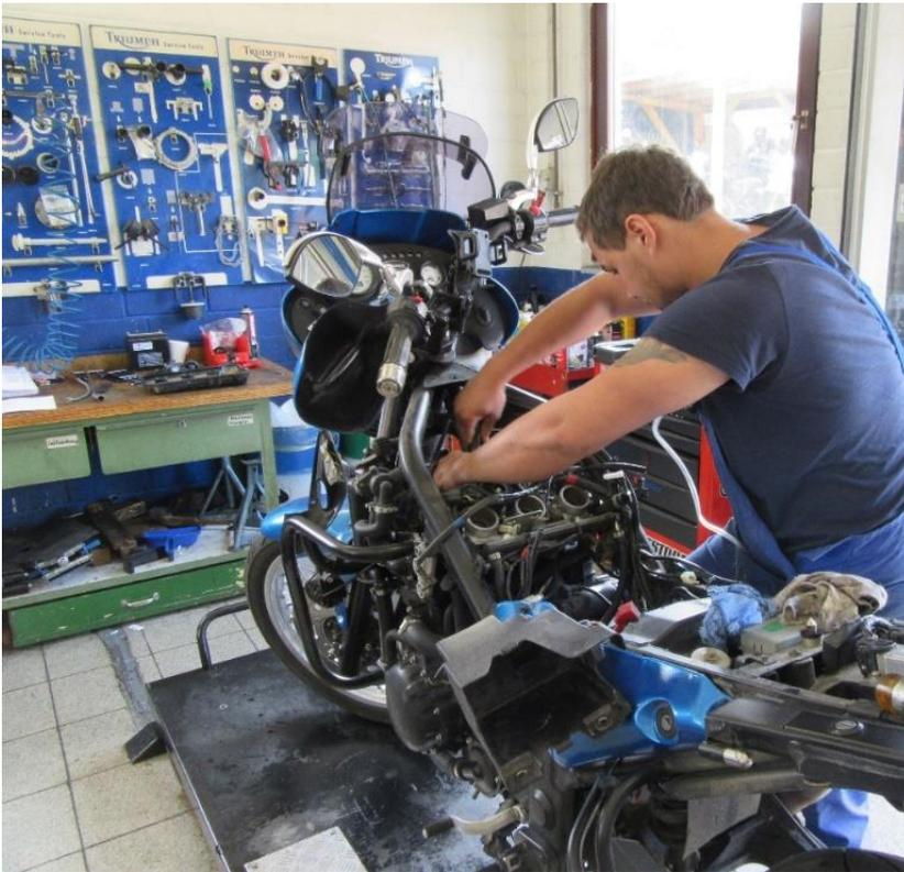
*Abbildung 1: Blick in eine Motorrad-Werkstatt. Der Beschäftigte arbeitet nach Entfernung des Zylinderkopfes am offenen Motor eines Motorrads und stellt das Ventilspiel ein.*
