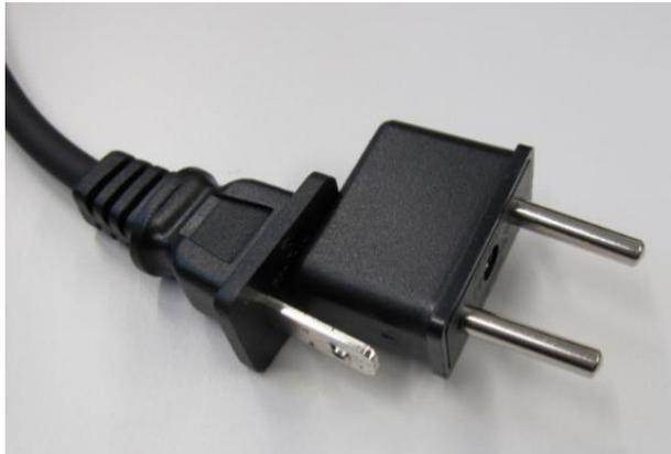
**Abbildung 2: Darstellung der Fehlanwendung des Reiseadapters**
