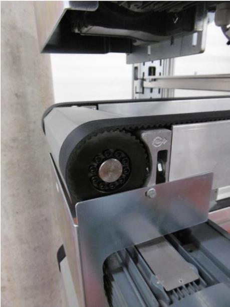
**Abbildung 2: Offene Eingriffsstelle am Zahnriementrieb**
