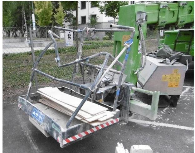
**Abbildung 3: Der zerstörte Arbeitskorb, in dem sich die verunglückte Person befand**
