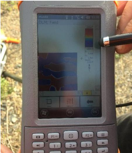
**Abbildung 1 – 3: Sondierungsgeräte mit kleinem Monitor, auf dem Bodenanomalien erkennbar werden**
