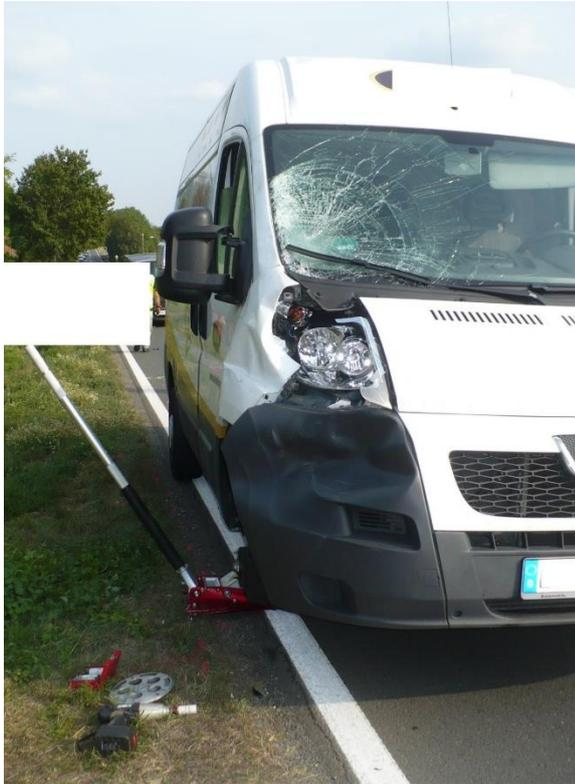
**Abbildung 2: Beschädigungen am Unfallfahrzeug – der Reifen am Fahrzeug wurde zum Vergleich mit den am Unfallort vorhandenen Reifenspuren demontiert**
