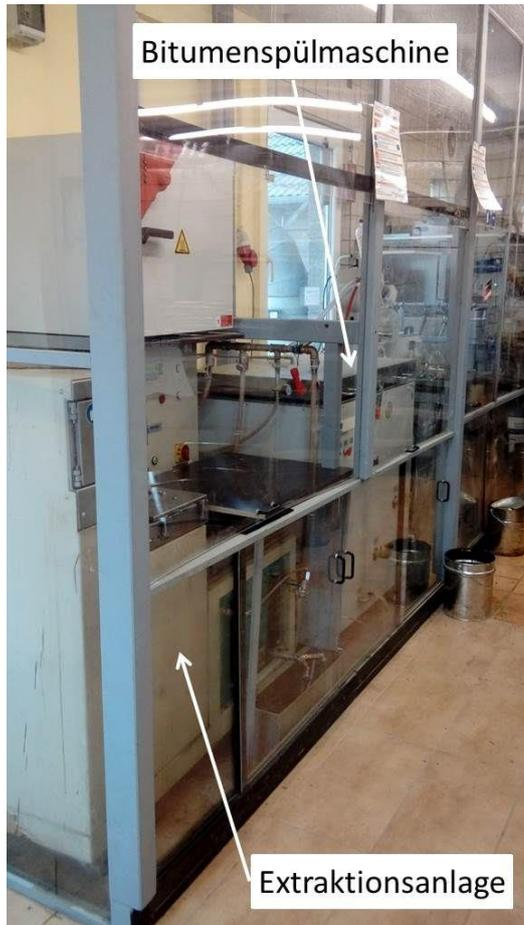
**Abbildung 1: Abgesaugte, wirksamkeitsgeprüfte Einhausung, in der sich zwei Extraktionsanlagen nach dem Waschtrommelverfahren, eine geschlossene Bitumenspülmaschine, ein Trockenschrank sowie zwei Rotationsverdampfer befinden.**
